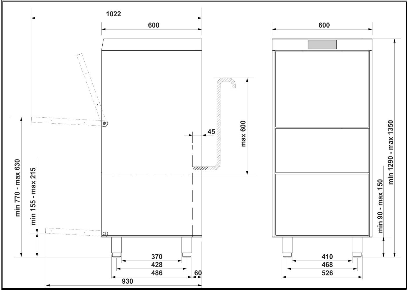
**Данная машина закрепляется на стене при помощи специального комплекта, входящего в состав поставки.**
