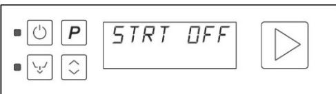
Если она настроена на "вкл.", то цикл запускается при закрытии дверцы/капота. Если она настроена на "выкл.", то цикл запускается после подтверждения запуска кнопкой запуска .
