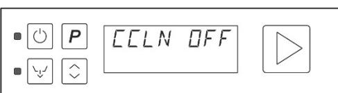
Включение этой функции предусматривает полный слив воды из бака и его последующее заполнение чистой водой для каждого цикла мойки. Продолжительность этой операции зависит от температуры поступающей воды.
