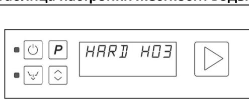
При наличии показателей выше 60°f следует использовать наружное устройство для подготовки воды и **настроить периодичность регенерации на**
