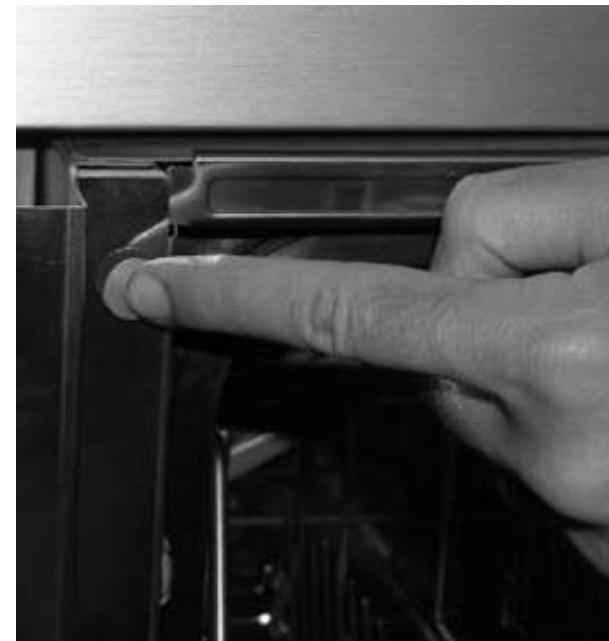
**IT** - Dopo aver sovrapposto al fianco l'angolare corrispondente riavvitare la vite frontale fissando profilo e fianco alla macchina. Riposizionare il tappo di copertura
