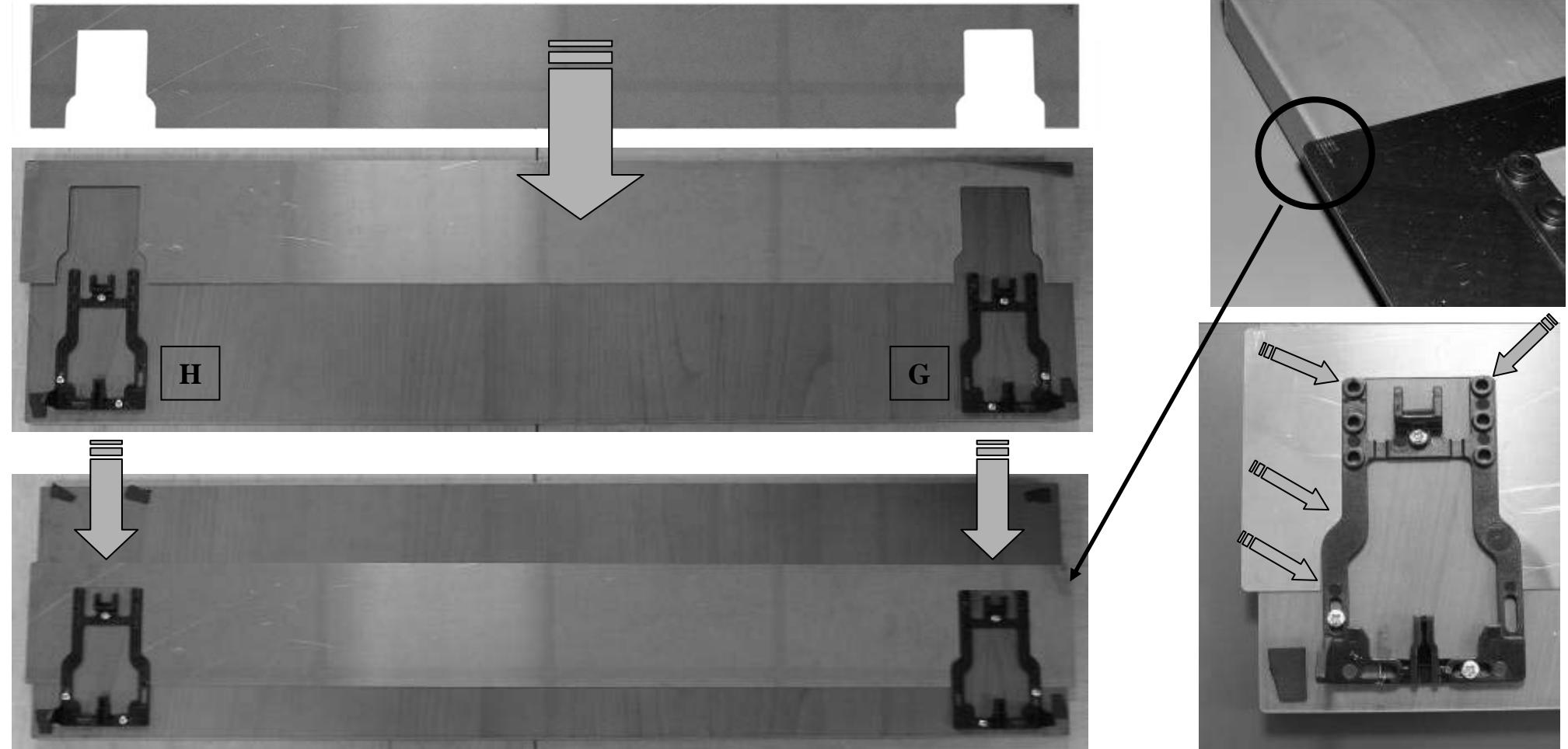
**PT** - Posicionamento dos enganches para rodapé: depois de definir a posição dos enganches para rodapé (**G-H**) com o uso do gabarito de cartão presente nos acessórios da máquina, verificar a exactidão do posicionamento com o gabarito metálico e apertar totalmente os parafusos.
