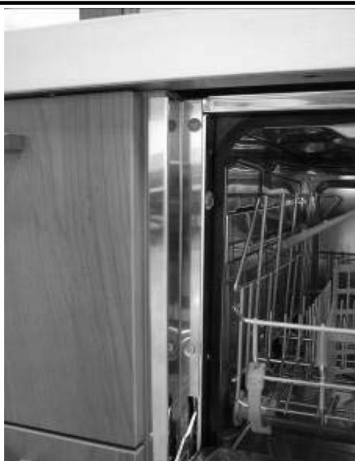
Incassare la macchina e se necessario fissarla lateralmente nei fori dei profili laterali.
