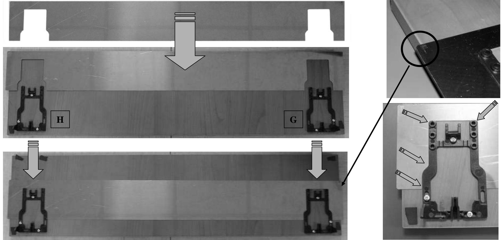
**SV** - Placering av socketkrokar: Bestäm var socketkrokarna (**G-H**) ska placeras med hjälp av mallen av kartong (medföljer bland diskmaskinens tillbehör). Använd stålmallen för att kontrollera att de är korrekt placerade. Dra sedan åt skruvarna helt.
