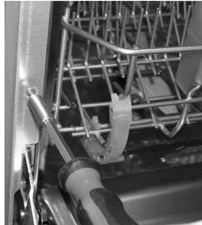
**ES- Fijación perfiles laterales:** Desenganchar el tapón de cobertura del agujero para el tornillo de regulación resorte bisagra y desenroscar el tornillo inferior que fija frontalmente el costado.
