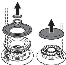
Перед тем, как включить конфорки варочной поверхности, убедитесь, что корончатые рассекатели и крышки на них установлены в соответствующих пазах. Положение отверстий конфорки должно совпадать со свечами и термопарами. Кроме того, необходимо проконтролировать, чтобы выступы корончатых рассекателей исправно входили в отверстия конфорки.
