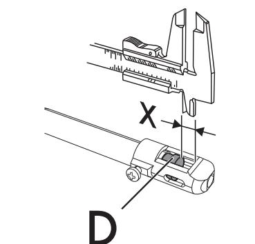
10. Отрегулируйте приток воздуха, сдвинув трубку Вентури "D" до получения расстояния "X", указанного в соответствующих таблицах (см. "Таблицу характеристики конфорок и форсунок", пункт "Первичный воздух (мм)", и закрепите ее винтом "A".
