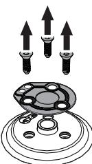
5. Снимите прокладки, имеющиеся на термопарах и свечах каждой конфорки.
