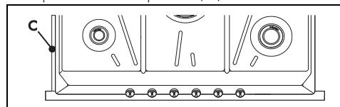
**!** Не закрепляйте варочную панель при помощи силикона, так как это приведет к повреждению варочной панели в случае ее демонтажа.
