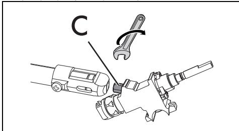
8. С помощью жесткого ключа снимите форсунки "C" и установите форсунки, подходящие для нового типа газа, следуя указаниям, приведенным в
