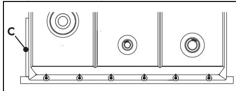
Не закрепляйте варочную панель при помощи силикона, так как это приведет к повреждению варочной панели в случае ее демонтажа.
