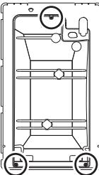
Вкрутите крепежные скобы в отмеченные отверстия, чтобы правильно закрепить варочную панель на встроенной конструкции.
