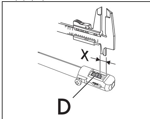
10. Отрегулируйте приток воздуха, сдвинув трубку Вентури "D" до получения расстояния "X", указанного в соответствующих таблицах (см. «Таблицу характеристик конфорок и форсунок», пункт «Первичный воздух (мм)», и закрепите ее винтом "A".
