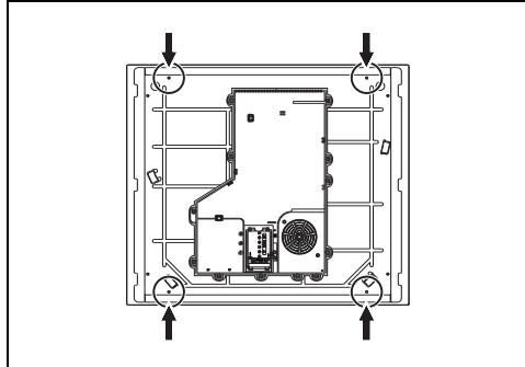
2. Для правильного крепления варочной панели к конструкции ввинтите крепежные кронштейны (A) в отверстия, намеченные ранее удаленными винтами.
