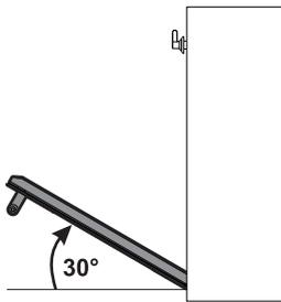
3. Para volver a montar la puerta coloque las bisagras en las hendiduras correspondientes situadas en el horno asegurándose de que las ranuras **A** se apoyen completamente en las hendiduras. Baje la puerta y, una vez posicionada, quite los pernos de los agujeros de las bisagras.
