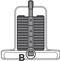
4. Extraiga el quemador sacándolo hacia afuera hasta que se pueda acceder al inyector.
