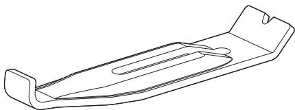
Чтобы правильно закрепить варочную панель на тумбе для встраивания, ввинтите крепежные кронштейны в специальные отверстия.
