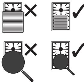
Во время приготовления пищи, чтобы избежать ожогов, повреждение варочной панели или столешницы, все емкости или сковороды-грили должны быть расположены в пределах периметра варочной панели.
