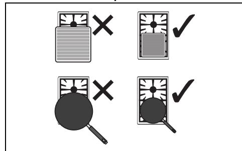
Во время приготовления пищи, чтобы избежать ожогов, повреждение варочной панели или столешницы, все емкости или сковороды-грили должны быть расположены в пределах períметра варочной панели.
