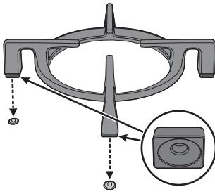
Удостоверьтесь, что решетки были просто отцентрированы на соответствующих горелках, чтобы они не находились в приподнятом или наклоненном положении; в противном случае следует повторить их установку.
