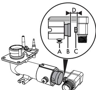
1. Отверните винт А и задвиньте до упора регулятор воздуха В.
