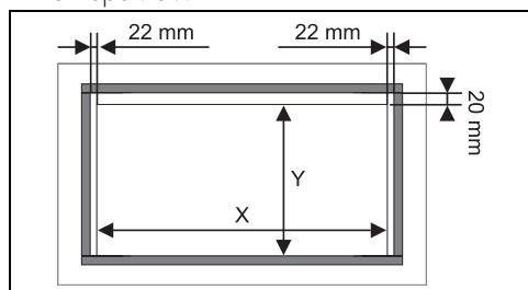
2. Приклейте ее, слегка нажимая, на поверхность внешнего периметра отверстия, выполненного в столешнице.
