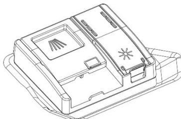
O abrillantador ajuda a loiça a secar mais rapidamente e impede a formação de manchas e depósitos de calcário; é adicionado automaticamente à água durante o ciclo de enxaguamento final, a partir do compartimento situado no interior da porta.
