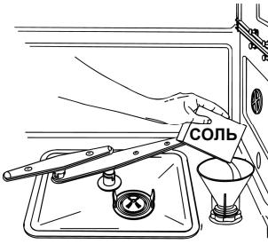
Используя воду со средней жесткостью, загрузку новой соли нужно будет выполнить приблизительно через **20 циклов мойки**. Емкость бачка смягчителя воды составляет около **1 кг** гранулированной соли. Бачок расположен на дне посудомоечной машины. Вынув нижнюю корзину, отвинтите пробку бачка, вращая ее против часовой стрелки, и насыпьте соли, используя воронку, входящую в комплект машины. Перед тем, как завинтить пробку, удалите остатки просыпавшейся соли вокруг горловины.
