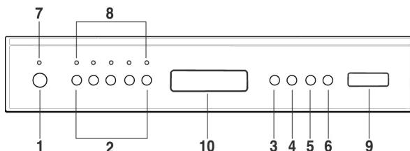
Для отображения следующей функции вновь нажмите кнопку **ВЫБОР ФУНКЦИЙ** ↓ ⏪. Для подтверждения функции нажмите кнопку **ПОДТВЕРЖДЕНИЕ ФУНКЦИИ**  (индикатор перестанет мигать и будет постоянно гореть). Эта операция возможна для одной или для всех имеющихся функций. Для отключения уже подтвержденной функции нажмите кнопку **ВЫБОР ФУНКЦИЙ** ↓ ⏪, чтобы начал мигать нужный ИНДИКАТОР ФУНКЦИИ, после чего нажмите кнопку **ПОДТВЕРЖДЕНИЕ ФУНКЦИИ**  . Индикатор перестанет мигать и погаснет.
