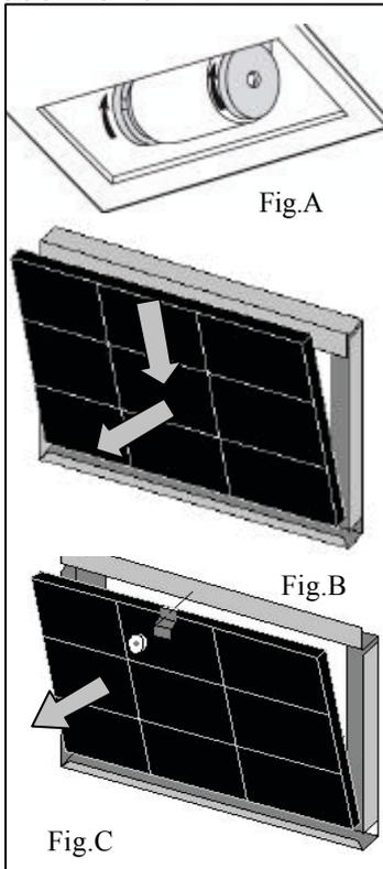
I filtri al carbone hanno la capacità di trattenere gli odori fino a che i carboni non raggiungono il livello di saturazione. Non sono lavabili, non sono rigenerabili e pertanto si raccomanda la loro sostituzione almeno una volta ogni sei mesi o con cadenze più frequenti nel caso di un utilizzo particolarmente severo della cappa.
