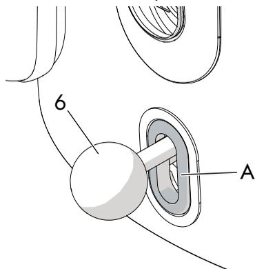
Рычаг включения/выключения активирует/прерывает цикл кипячения. Во время работы бойлера светодиод **A** загорается белым светом.
