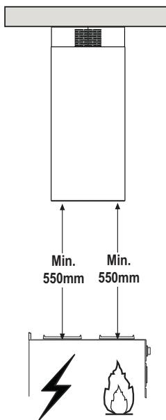
\* Габариты всасывающей вытяжки.
