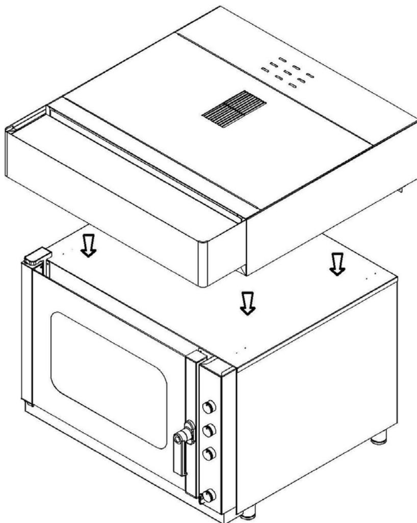
Необходимо соединить выпускную горловину для отвода дыма из духовой печи с дымоотводящей трубой, расположенной сзади вытяжки, используя входящий в комплект поставки шланг, после чего следует закрепить все собранные детали металлическими хомутами, тоже входящими в комплект поставки.
