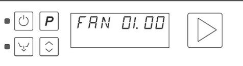
Предназначена для отображения и настройки времени включения всасывания пара.
