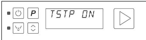
**При настройке на "вкл." = минимальная температура ополаскивания** соответствует настроенной (см.
