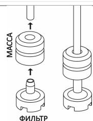
Перед тем, как вставить трубы в резервуары, закрепить на концах груз (необходимый для удержания трубы подачи на дне) и фильтр как указано на картинке. Если дозатор моющего средства не установлен изначально, его можно установить заказав соответствующий набор деталей.
