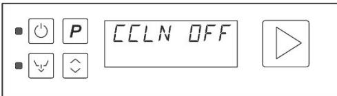
Включение этой функции предусматривает полный слив воды из бака и его последующее заполнение чистой водой для каждого цикла мойки. Продолжительность этой операции зависит от температуры поступающей воды.
