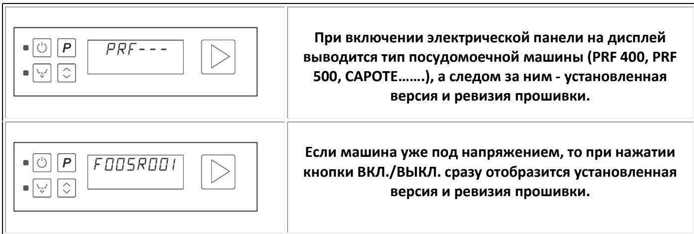
При включении электрической панели на дисплей выводится тип посудомоечной машины (PRF 400, PRF 500, CAPOTE.....), а следом за ним - установленная версия и ревизия прошивки.
