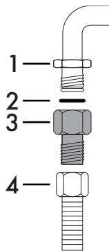
Аккуратно привинтите фитинг 3 к газовому патрубку 1 (резьба 1/2 дюйма ISO 228-1) прибора, проложив прокладку 2 из комплекта поставки. Нанесите изоляционный материал на резьбу патрубка
