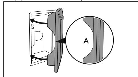
7. Нажмите на крышку таким образом, чтобы она плотно прилегала к патрону лампочки.
