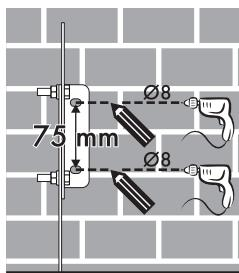
4. Выровняйте основу крюка крепежной скобы с основой отверстия пластины крепления к стене.
