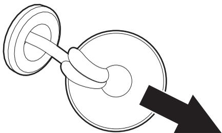
В случаях перебоев с электроснабжением следует потянуть за шнур, расположенный позади прибора и открыть дверцу вручную.
