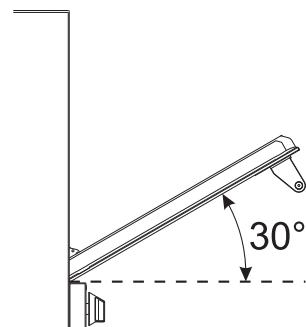
Для повторной установки вставить петли в специальные отверстия, имеющиеся в духовке, убедившись в том, что желобки **С** прислоняются полностью на отверстия. Опустить дверцу вниз и после ее установки вынуть стержни из отверстий петель.
