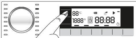
Prima o botão de **Ajuste da temperatura** para alterar a temperatura. A temperatura diminuirá em intervalos de 10°C.
