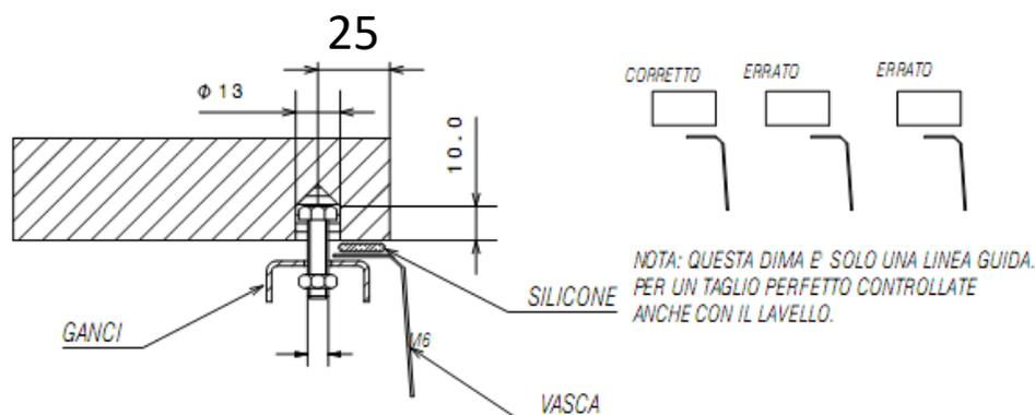
2) Determinare la posizione delle staffe di fissaggio. Eseguire i fori utilizzando gli utensili adatti al materiale del top.
