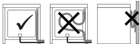
Efetue a ligação à rede de gás utilizando um tubo de borracha cujas características correspondam às indicadas na norma vigente (verifique se o tubo tem impressa a sigla desta norma).
