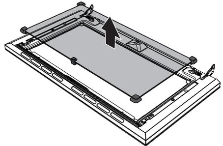
6. Limpe o vidro exterior e os anteriormente retirados. Utilize papel absorvente de cozinha. Em caso de sujidade persistente, lave com uma esponja húmida e detergente neutro.
