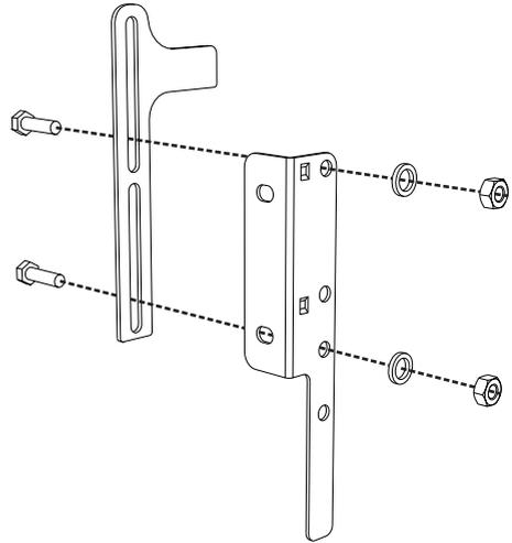
4. Alinhe a base do gancho do suporte de fixação à base do corte da pequena chapa de fixação à parede.
