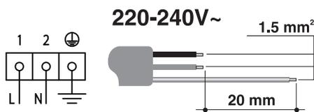
Cavo **tripolare 3 x 1,5 mm<sup>2</sup>**.
