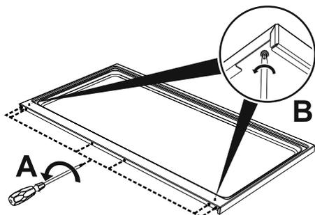
2. Posizionare l'alzatina sopra il pannello. Far corrispondere le 6 asole inferiori dell'alzatina con le 6 viti sul retro del pannello allentate precedentemente.
