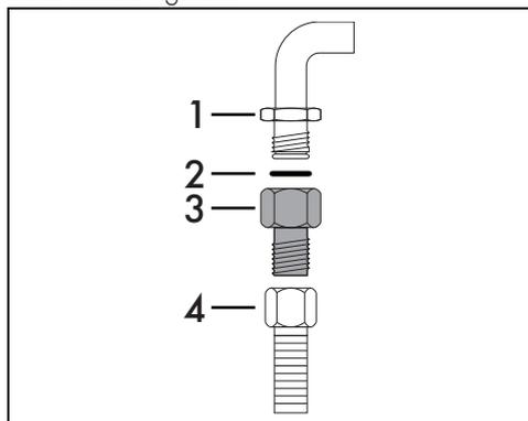
Avvitare accuratamente il raccordo 3 al raccordo gas 1 (filetto  $\frac{1}{2}$ " ISO 228-1) dell'apparecchio interponendo sempre la guarnizione 2 in dotazione. Applicare del materiale isolante sul filetto del raccordo 3, dopodiché avvitare il tubo flessibile in acciaio 4 al raccordo 3.
