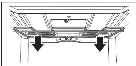
3. Al termine delle operazioni di pulizia riportare la resistenza in posizione e ruotare il fermo per agganciarla.
