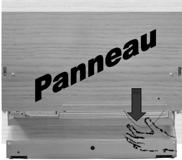
Un système d'ouverture manuelle « d'urgence » permet d'ouvrir le lave-vaisselle en cas de panne de courant. Il s'agit d'un cordon (que l'on peut attraper dans le bas à l'avant, même quand la porte est présente) qu'il faut tirer vers le bas pour débloquer la porte.
