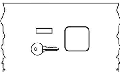
**BØRNESIKRING:** Tryk på knappen for at aktivere funktionen (kontrollampen tændes). Når funktionen er aktiveret, bekræftes åbning af lågen af tre bip. Tryk derefter på lågen, og hold den trykket inde, indtil det tredje bip høres. Slip derefter lågen med det samme. Lågen åbner ikke, hvis den holdes trykket inde efter det tredje bip. Gentag i dette tilfælde handlingen.
