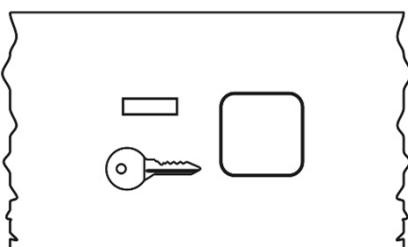
**KINDERBEVEILIGING:** druk op de knop om de beveiliging in te schakelen (het controlelampje gaat branden). Indien ingeschakeld zal ter bevestiging van de opening van de deur het geluidssignaal driemaal worden herhaald. U zult dus op de deur moeten drukken en hem tot aan de derde beep ingedrukt moeten houden, waarna u hem onmiddellijk moet loslaten. Wanneer u hem ook na de derde beep nog ingedrukt houdt zal de deur niet opengaan en zult u de handeling moeten herhalen.
