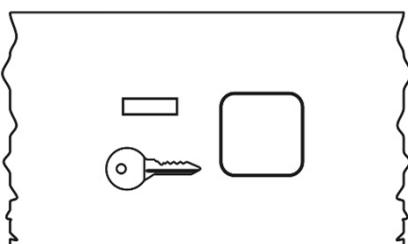
**SEGURANÇA PARA CRIANÇAS:** pressionar o botão para a activar (a lâmpada piloto acende). Quando está activa, a confirmação da abertura da porta é dada por um sinal acústico repetido três vezes. Portanto, é necessário carregar no painel de revestimento e manter a pressão até ouvir o 3º bip, soltando-o então imediatamente. Se a pressão for mantida depois do terceiro bip, a porta não se abre. Neste caso, será necessário repetir a operação.
