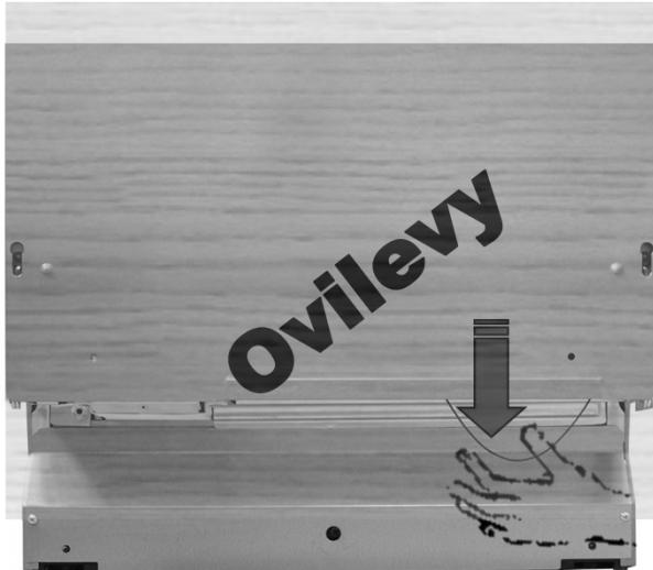
Astianpesukoneessa on hätätilanteita varten käskäyttöinen järjestelmä, jonka avulla oven saa auki vaikka sähköt olisivat poikki. Laitteen etuosan alareunasta pääsee tarttumaan lankaan (vaikka ovilevy olisi kiinnitetty), josta alaspäin vetäessä oven lukitus aukeaa.
