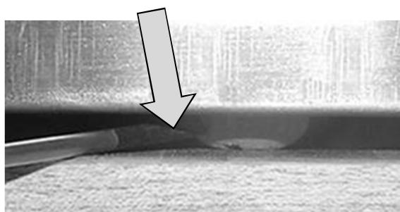
Перед установкой панели рекомендуется частично вывинтить (поворачивая против часовой стрелки) кнопку электрического открытия.
