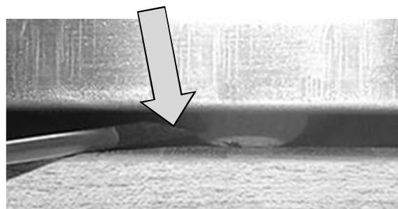
Før montering av dørpanelet er det lurt at du delvis trekker den elektriske åpningsknappen ut (ved å vri den mot klokken).
