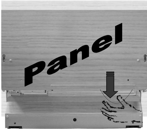
Un sistema de apertura manual de "emergencia" permite abrir el lavavajillas en caso de faltar la alimentación eléctrica. Se trata de una cuerdecilla (se alcanza por abajo en la parte delantera, incluso en presencia del panel) que, al ser tirada hacia abajo, desengancha la puerta.
