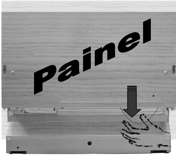
Um sistema de abertura manual de “emergência” permite abrir a máquina se faltar a alimentação eléctrica. Trata-se de um cordão (acessível por baixo na parte frontal, mesmo com o painel de revestimento instalado) que destrava a porta se for puxado para baixo.
