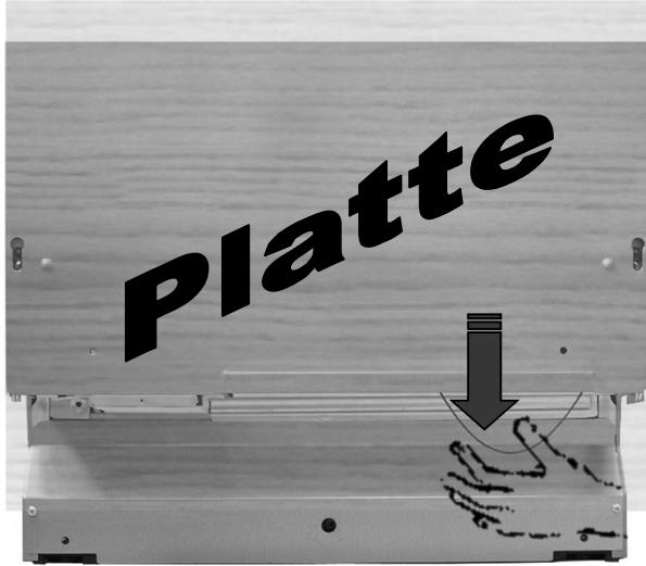
Die Gerätetür kann bei Stromausfall dank eines Notsystems von Hand geöffnet werden. Hierbei handelt es sich um eine Schnur (auch bei montierter Dekorplatte auf der Vorderseite unten zugänglich), die Sie nach unten ziehen müssen, um die Gerätetür zu öffnen.
