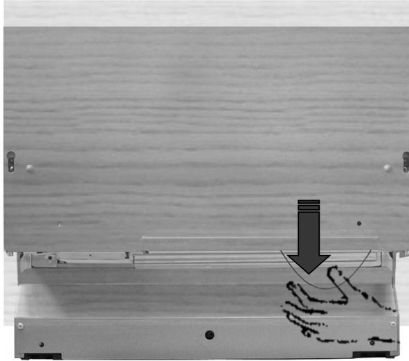
Et manuelt nødåbningssystem gør det muligt at åbne opvaskemaskinen i tilfælde af strømafbrydelse. Der er anbragt en lille snor, som kan nås under opvaskemaskinens forreste del, også selvom skabslågen er monteret. Træk snoren nedad for at åbne lågen.
