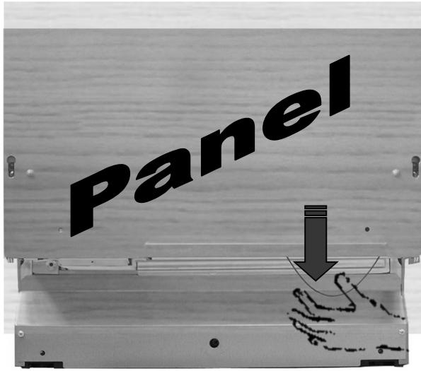
I händelse av strömbrott kan luckan öppnas manuellt om det skulle behövas. Det finns ett snöre för detta ändamål som du drar nedåt för att öppna luckan. Snöret sitter nedtill på framsidan och går att komma åt även när skåpsluckan är monterad.
