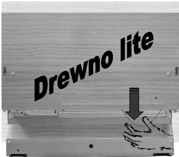
„Awaryjny” system ręcznego otwierania umożliwia otwarcie zmywarki w przypadku braku zasilania elektrycznego. Jest to linka (znajdująca się u dołu w przedniej części urządzenia, nawet jeżeli są obecne drzwi), której pociągnięcie na dół odblokowuje drzwiczki.
