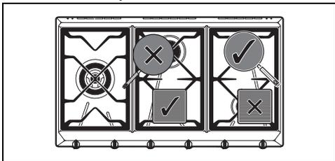
Durante la cottura, per evitare scottature, danni al piano o al top, tutti i recipienti o le bisticchiere devono essere posizionati all'interno del perimetro del piano di cottura.
