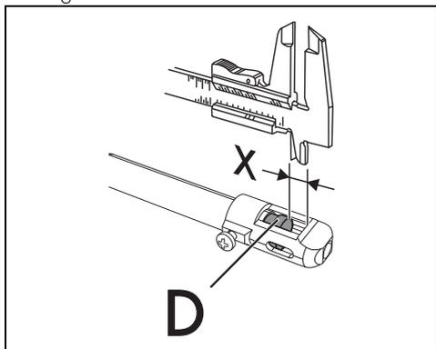
10. Regolare l'afflusso d'aria spostando il tubo Venturi "D", fino ad ottenere la distanza "X" riportata nelle tabelle relative (vedi: "Tabella caratteristiche bruciatori e ugelli", alla voce "Aria primaria (mm)"); successivamente, stringere la vite "A".
