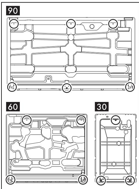
Avvitare le staffe di fissaggio negli appositi fori evidenziati per fissare correttamente il piano cottura alla struttura d'incasso.
