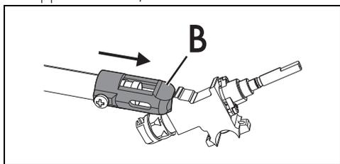
9. Riportare il supporto "B" nella posizione iniziale, in modo da coprire completamente l'ugello "C".
