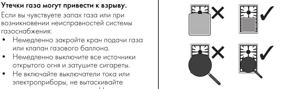
Во время приготовления пищи, чтобы избежать ожогов, повреждение варочной панели или столешницы, все емкости или сковороды-грили должны быть расположены в пределах периметра варочной панели.
