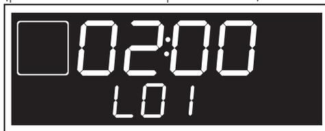
3. Rodar o botão da temperatura para definir a duração da Pirólise de um mínimo de 2 horas até um máximo de 3 horas.
