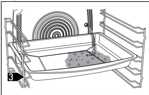
4. Aguarde que termine o fluxo de descarga. Terminada a operação, a luz indicadora do depósito
