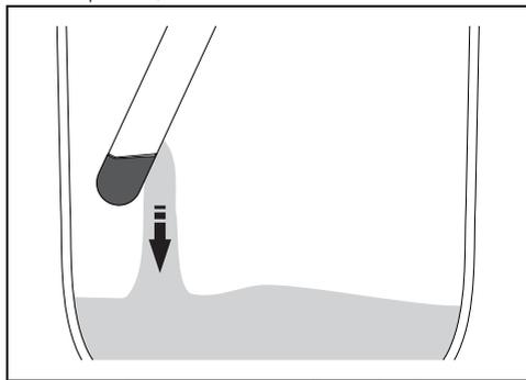
14. Aguarde que termine o fluxo de descarga. No final, o display exibe o fim do processo de remoção da água residual.
