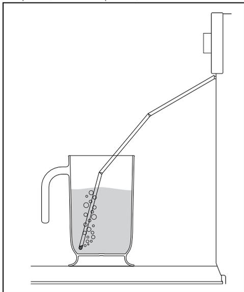
6. Toque na tecla INICIAR
