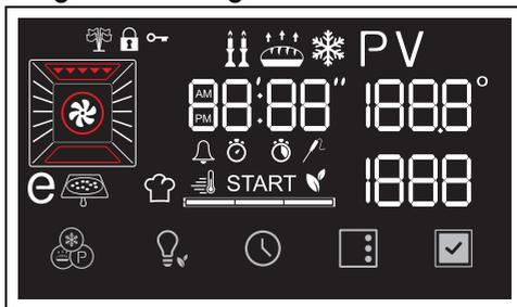
O ecrã mostra os parâmetros e os valores relativos à operação selecionada no momento. Para o utilizar é suficiente rodar os botões de funções e temperatura e/ou pressionar os botões presentes na parte baixa do ecrã, conforme as operações que desejam fazer executar ao aparelho.
