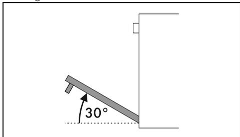
3. Para voltar a montar a porta, introduza as dobradiças nas respectivas fendas situadas no forno assegurando-se de que os sulcos **A** fiquem totalmente apoiados nas fendas.
