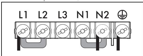
Cabo de três polos 3 x 6 mm<sup>2</sup>.
