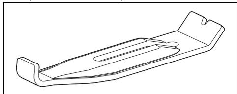
Avvitare le staffe di fissaggio negli appositi fori per fissare correttamente il piano cottura alla struttura d'incasso.
