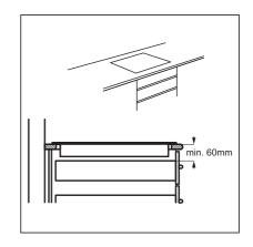
Se o aparelho for instalado por cima de uma gaveta, a ventilação da placa durante o funcionamento pode aquecer os produtos que estiverem guardados na gaveta. Pode instalar um painel de separação, mas não é obrigatório.
