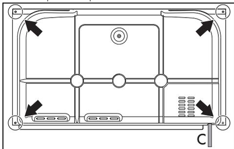
2. Levante ligeiramente o cárter superior e retire o cárter traseiro para aceder à placa de bornes.
