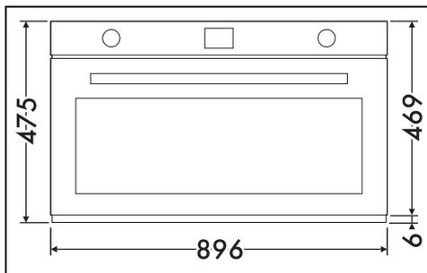
Encaixe em coluna (mm)
