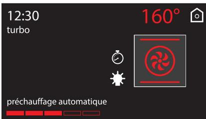
4. À la fin du préchauffage, un signal sonore intervient pour indiquer que les aliments peuvent être enfournés dans la chambre de cuisson.
