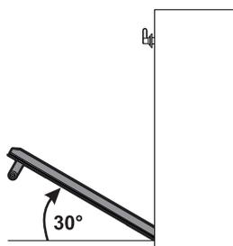
3. Para voltar a montar a porta, introduza as dobradiças nas respectivas fendas situadas no forno assegurando-se de que os sulcos **A** fiquem totalmente apoiados nas fendas. Baixe a porta e em seguida remova os pernos dos orifícios das dobradiças.
