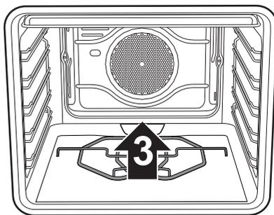
3. Volte a adaptar a base de apoio da pedra para pizza empurrando-a até à retenção contra a parte de trás do compartimento de cozedura e baixe-a até que a pequena placa da resistência encaixe na base da mesma.
