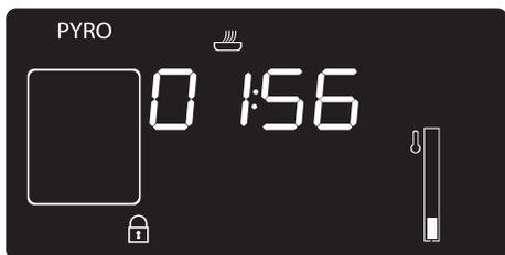
1. No display aparece a indicação **PYRO** ou **ECO** e o tempo restante para indicar que o aparelho está a efetuar o ciclo de limpeza automático.
