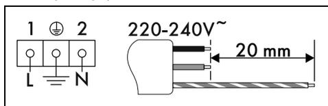
Cavo tripolare 3 x 1,5 mm<sup>2</sup>.
