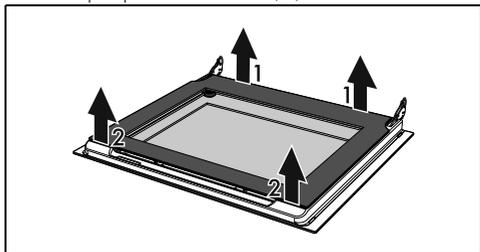
3. Décrochez les taquets avant en suivant le mouvement indiqué par les flèches (2).
