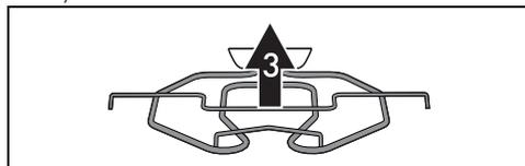
Remplacez la sole d'appui de la pierre à pizza, en la poussant contre le panneau de fond du four et abaissez-la de manière à ce que la plaquette de la résistance s'encastre dans la base.
