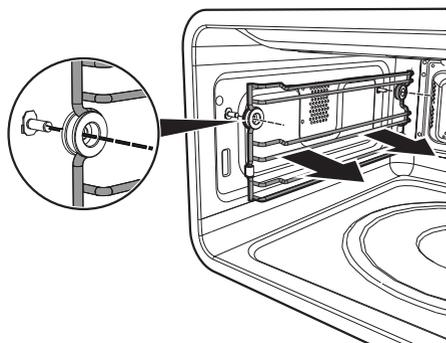
3. Al termine della pulizia ripetere le operazioni appena descritte per riposizionare i telai guida. Prestare attenzione alle boccole distanziali da inserire all'interno della sagomatura del telaio.
