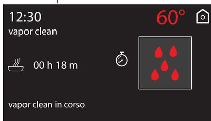
4. Nel caso in cui la temperatura all'interno del vano cottura sia troppo elevata, un segnale acustico ed un avviso sul display segnalano di attendere il raffreddamento.
