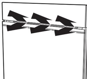
La ventola provvede a raffreddare il forno ed entra in funzione durante la cottura. Il funzionamento della ventola provoca un normale flusso d'aria che esce sopra la porta e che può continuare per un breve periodo anche dopo lo spegnimento dell'apparecchio.
