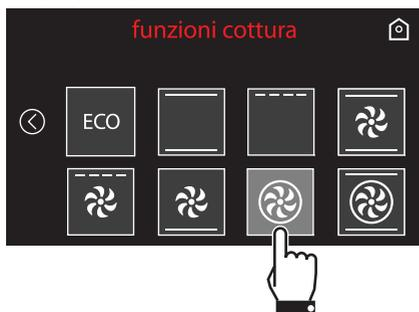
4. L'apparecchio inizierà la fase di preriscaldamento. Sul display verrà visualizzata la funzione scelta, la temperatura preimpostata, l'ora corrente e l'avanzamento del raggiungimento della temperatura ( preriscaldamento).
