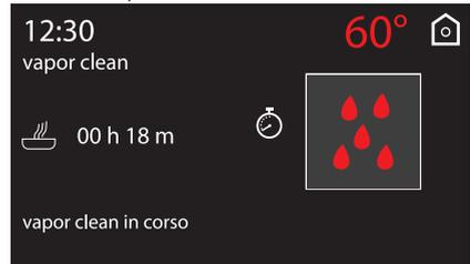
4. Nel caso in cui la temperatura all'interno del vano cottura sia troppo elevata, un segnale acustico ed un avviso sul display segnalano di attendere il raffreddamento.
