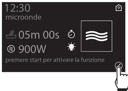
11. Sul display verrà visualizzata la funzione scelta, la potenza impostata, l'ora corrente ed il tempo residuo alla fine della funzione.
