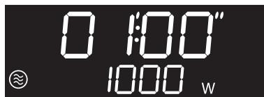
2. Ruotare la **Manopola Selezione**
