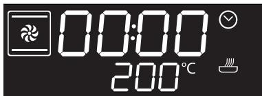
2. Entro 3 secondi ruotare la **Manopola Selezione**
