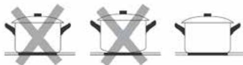
Accertarsi che il fondo del tegame sia liscio, poggi a filo sul vetro e che sia di dimensione pari a quella della zona di cottura. Centrare sempre il tegame sulla zona di cottura. Togliere sempre i tegami dal piano di cottura in ceramica sollevandoli: non farli scivolare, in quanto potrebbero graffiare il vetro.
