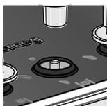
Col tempo, può accadere che il rubinetto del gas presenti difficoltà di rotazione bloccandosi. Provvedere alla sua pulizia interna e sostituirne il grasso lubrificante. Questa operazione andrà eseguita da un tecnico specializzato.
