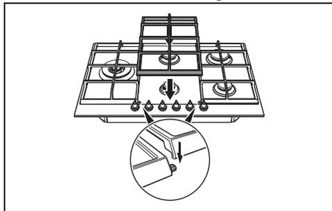
Preste ainda atenção à gravação “FRONT” existente debaixo de cada grelha na parte dianteira, como indicação adicional para posicionar corretamente as grelhas na placa.
