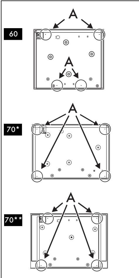
Aperte os suportes de fixação nos respectivos furos para fixar corretamente a placa de
