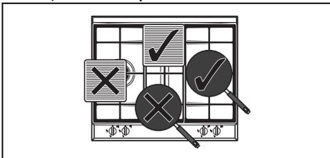
Durante a cozedura, para evitar queimaduras, danos na placa ou no topo, todos os recipientes ou grelhas devem ser colocados dentro do perímetro da placa de cozinha.
