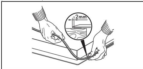
**!** Não fixe a placa de cozinha com silicone. Neste caso, não permitirá a remoção da placa de cozinha sem a danificar.
