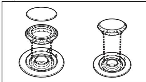
Antes de ligar os queimadores da placa, assegure-se de que os espalhadores estão colocados nas suas bases com as respetivas tampas. Tenha em atenção que os orifícios dos queimadores correspondam às velas e aos termopares. Verifique também se os encaixes dos espalhadores estão corretamente inseridos nos orifícios do queimador.
