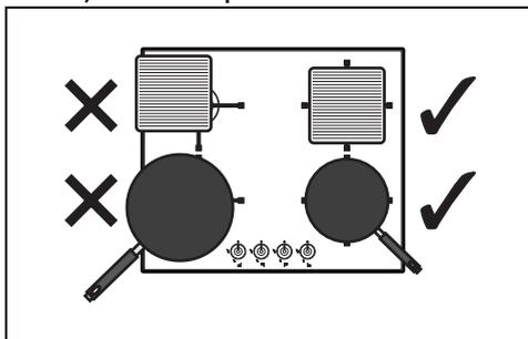
Durante a cozedura, para evitar queimaduras, danos na placa ou na bancada, todos os recipientes ou grelhas devem ser colocados dentro do perímetro da placa de cozinha.
