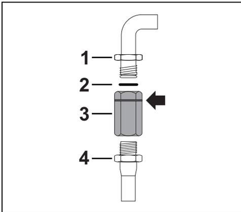
Aplique material isolante na rosca da conexão do tubo de gás 4 e enrosque o adaptador 3. Enrosque o bloco à conexão móvel 1 à do aparelho, interpondo sempre o vedante 2 fornecido.
