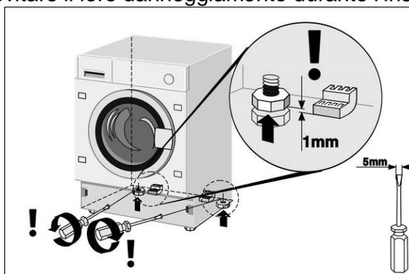
Dopo avere inserito l'apparecchio nella cucina, è necessario alzare i piedini posteriori, per evitare che la macchina appoggi sulle slitte. Dopo avere alzato i piedini posteriori, procedere con il livellamento della macchina ed il fissaggio dei piedini anteriori.
