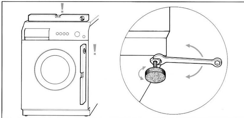
3. In presenza dei **piedini regolabili posteriori**, fare attenzione al fatto che nella parte posteriore la macchina non appoggi sulle slitte. Verificare, prima di inserire la macchina nella cucina, che i piedini posteriori siano completamente avvitati, per evitare il loro danneggiamento durante l'inserimento.
