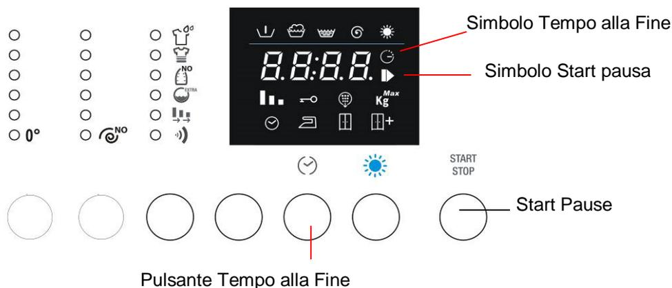
1. Premendo ripetutamente il pulsante Tempo alla Fine è possibile selezionare dopo quanto tempo il programma di lavaggio avrà termine. Il tempo al termine del ciclo tiene conto della durata iniziale del ciclo di lavaggio/asciugatura, delle impostazioni fatte (temperatura, velocità centrifuga e opzioni), che possono ridurre oppure allungare la durata iniziale del ciclo e del tempo di attesa che l'utente vuole aggiungere prima della partenza.
