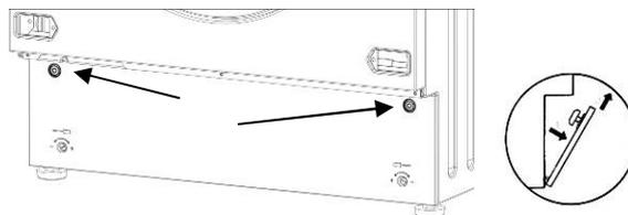
Modello Libera Installazione – Inserire un cacciavite di piccole dimensioni nelle feritoie praticate sulla porta anteriore dello zoccolo, quindi fare leggermente leva con il cacciavite verso l'alto in modo tale da liberare la parte superiore dello zoccolo stesso del mobile. Inclinare leggermente in avanti lo zoccolo e tirare verso l'alto per toglierlo completamente.
