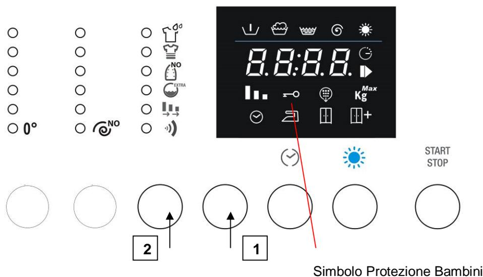
1. Quando questa funzione è attiva non è possibile modificare le opzioni, la temperatura, la velocità della centrifuga e il ciclo di lavaggio/asciugatura mentre il ciclo è in corso.
