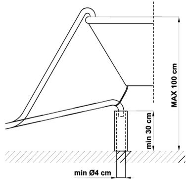
El extremo libre deberá ser colocado a una altura entre **30 y 100 cm**, y nunca deberá ser sumergido en agua. Si se usa una manguera de desagüe de extensión horizontal (de máximo 3 m) la manguera de desagüe puede ser colocada a una altura máxima de **85 cm** respecto al suelo.
